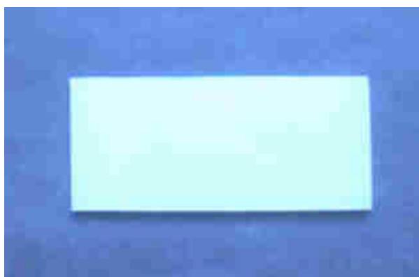
Fig. 7.- Muestra de Hule Silicón cubierta con caolín.
