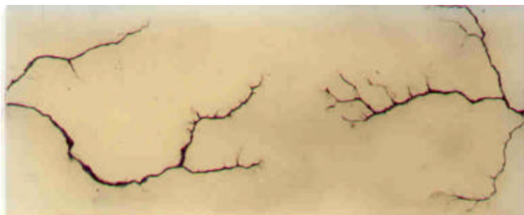
Fig. 13.- Trayectoria eléctrica con ramificaciones y que no se une.
