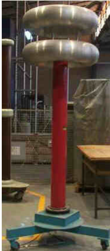
Fig. 6.- Divisor de Tensión RC.
