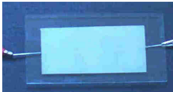
Fig. 8.- Muestra de Hule Silicón cubierta con caolín y con los electrodos de tungsteno.
