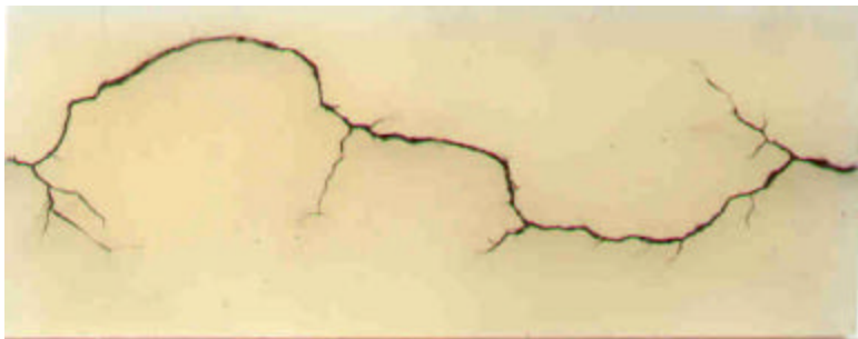
Fig. 12.- Trayectoria eléctrica zigzagueante y que se termina uniendo.
