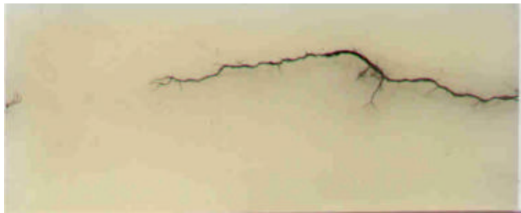
Fig. 15.- Trayectoria eléctrica incompleta
