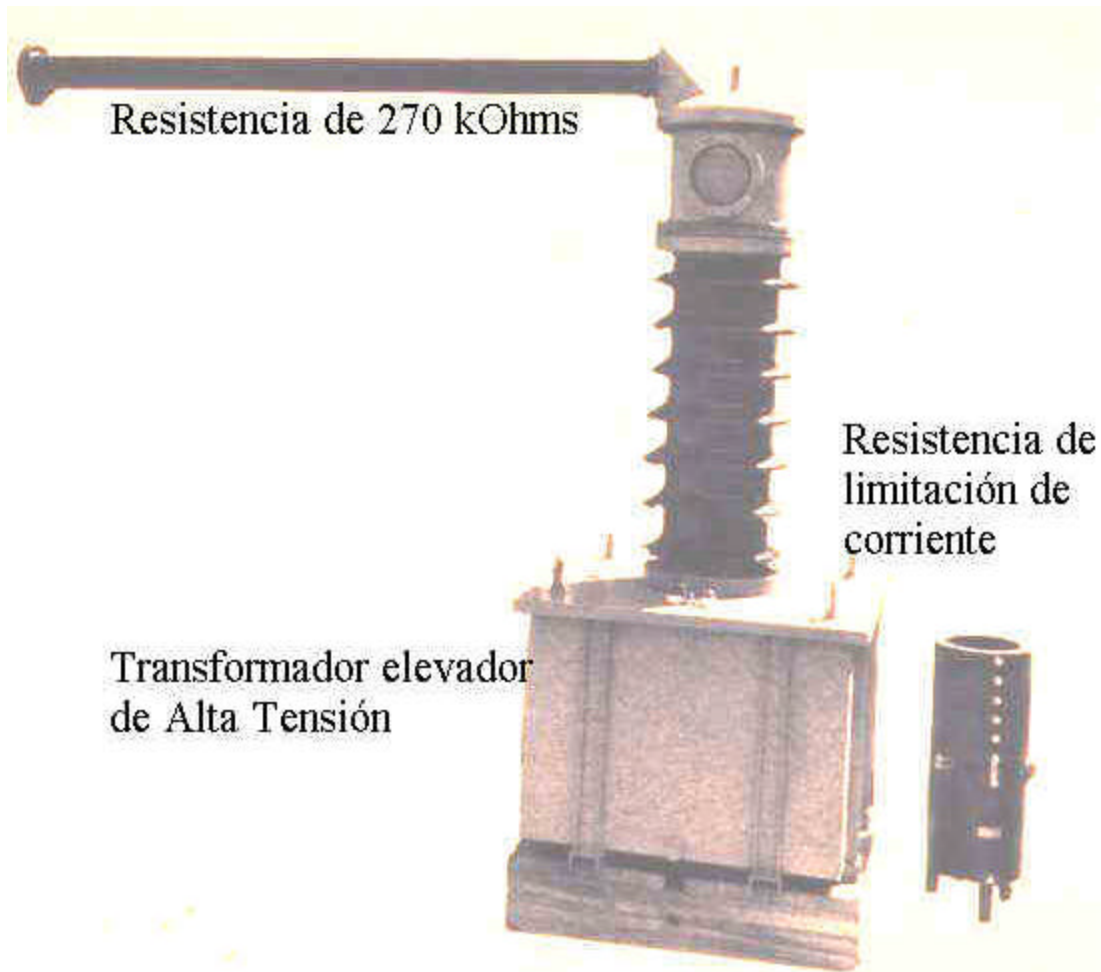
Fig. 5.- Partes que constituyen la Fuente de C.A.
